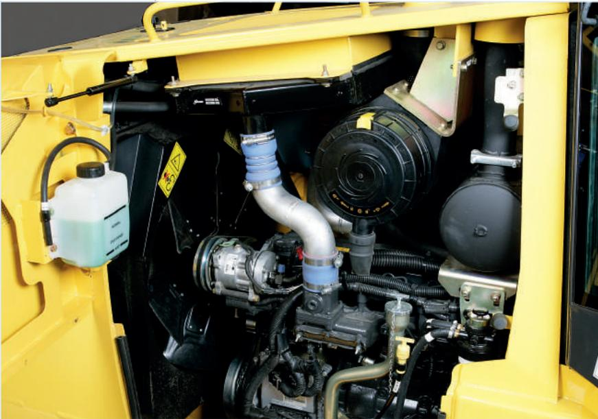
**E**l nuevo motor New Holland Common-Rail, de alta tecnología, fue diseñado para desarrollar potencia y par elevados y para proporcionar una reducción en el consumo de combustible y en la emisión de contaminantes. Genera una potencia 12% mayor con la misma rotación del cigüeñal (2.200 rpm) y un aumento de par máximo de 690 Nm (comparado con los 60 Nm del modelo anterior).
